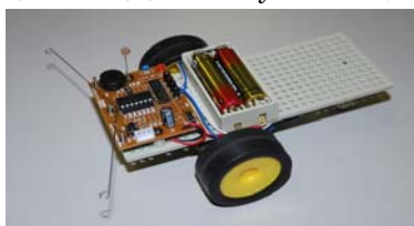
図 11 検証に使用した車型の自律型ロボット
